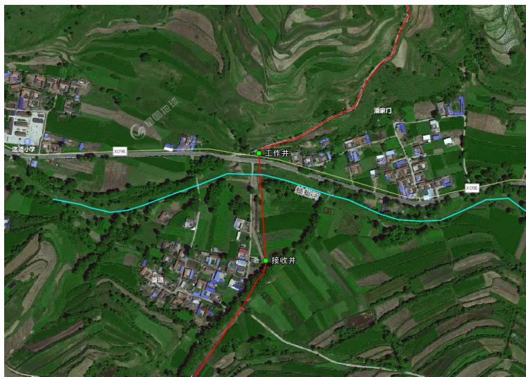
顶管穿越岷蜓河、X098 (县道)
